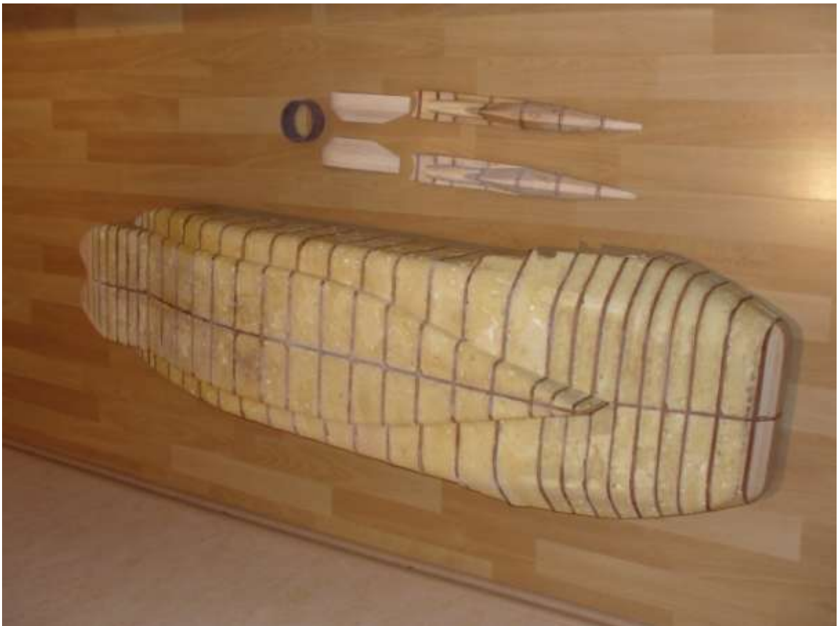
Mittels Gewindestangen wurde alles ausgerichtet und mit Bauschaum ausgeschäumt.
