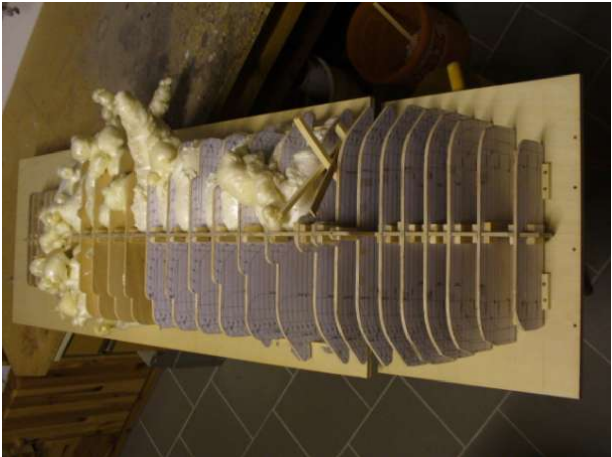
Mittels Gewindestangen wurde alles ausgerichtet und mit Bauschaum ausgeschäumt.
